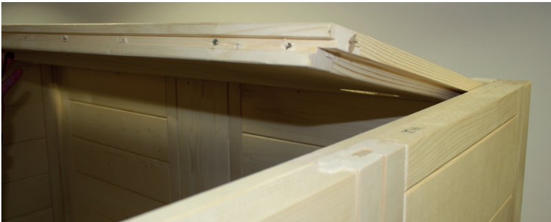
Abb. 18: Einlegen Dachelemente vorne
